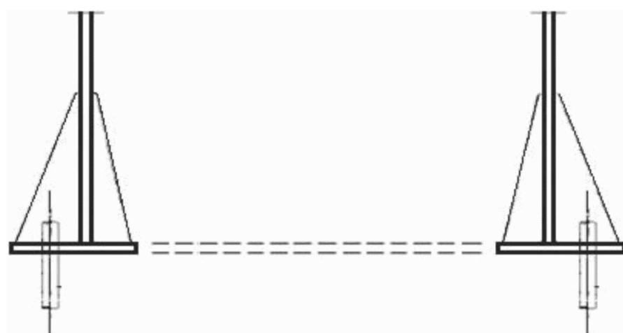
Рисунок 13.2 - Опорная плита с подкрепляющими ребрами
