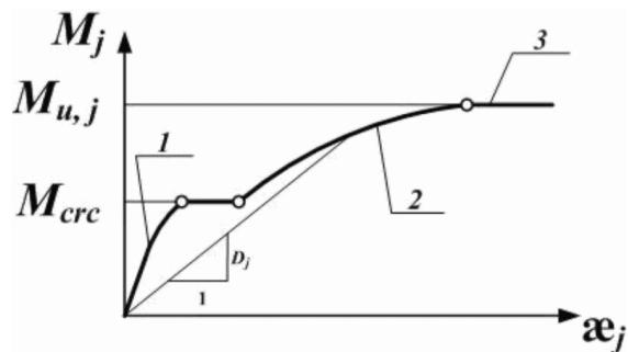
1 - участок работы без трещин;
