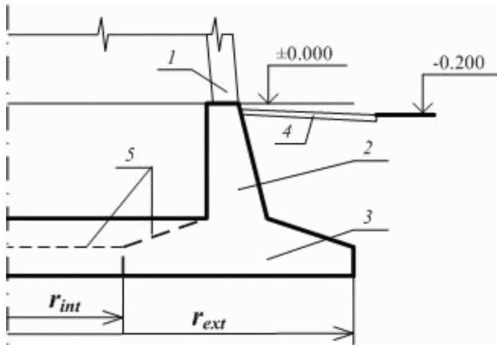
1 - ствол трубы; 2 - стакан фундамента; 3 - фундаментная плита; 4 - отмостка; 5 - очертание фундаментной плиты для кольцевого фундамента;  $r_{ext}$  и  $r_{int}$  - наружный и внутренний радиусы фундаментной плиты
