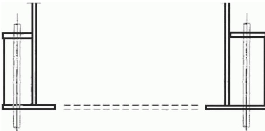
Рисунок 13.3 - Опорная плита с подкрепляющими ребрами
